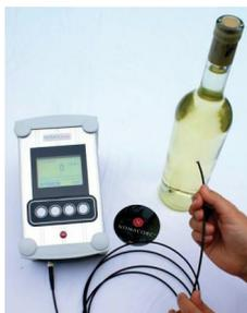
Depuis plusieurs années, nous avons développé notre savoir-faire sur la mesure de l'oxygène dissous, mesuré en ligne grâce à l'appareil NomaSense O<sub>2</sub> Trace. Cette technique brevetée permet de mesurer l'oxygène dans le vin et dans les gaz sans réaliser de prélèvement, au travers d'un mireur ou d'une bouteille équipée d'un capteur de mesure, ou grâce à un dispositif externe pour les bouteilles, le Piercing System.
