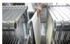
Les plaques filtrantes sont utilisées dans des filtres à plateaux ou à cadre. Les plaques doivent être humidifiées quand le filtre est monté et nécessite un pré-rinçage d'au moins 50 litres/m<sup>2</sup>. Une différence de pression entre l'entrée et la sortie assure un flux constant. Les plaques sont usées lorsque la différence de pression augmente au-delà de la valeur indiquée.
