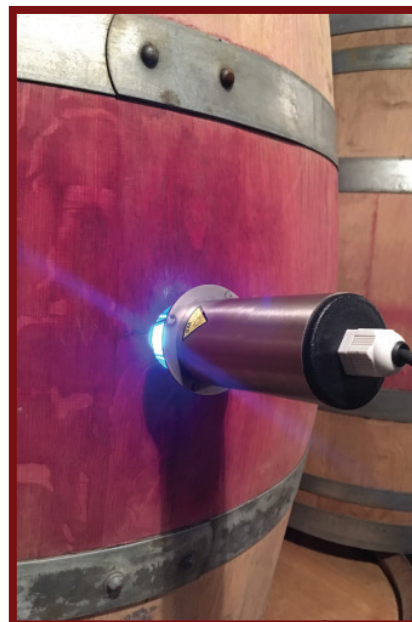
Traitement UV d'un fût
