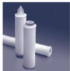
La cartouche est placée dans un carter spécial. Le liquide trouble remplit l'espace entre le carter et la partie extérieure de la cartouche. Le liquide traverse l'épaisseur du média dans lequel sont retenues les particules de troubles. Le liquide clarifié est collecté dans la partie centrale rigide vers la sortie du filtre.
